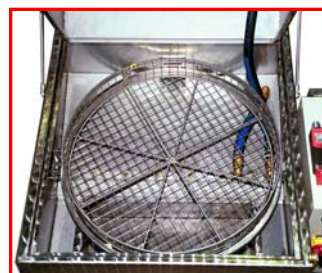
Waschkorb, motorgetrieben mit 4-fach Lagerung
