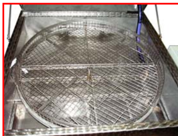
Waschkorb mit multipler Lagerung sowie Zentrumsunterstützung
