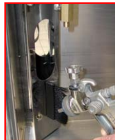
Reinigung der Luftkappe mittels Bürstenleiste
