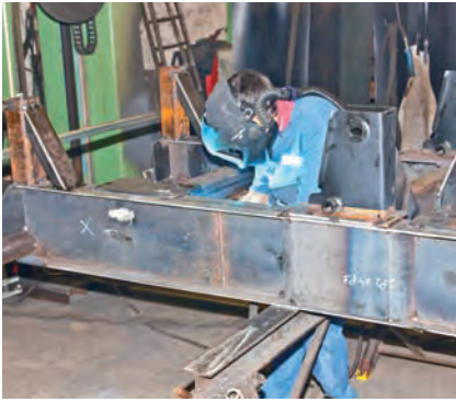
Die Schweißarbeiten für ein Standard-Chassis dauern etwa acht Stunden.
