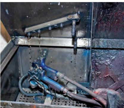
Die Reinigung von Pistole und Düse von außen erfolgt mit einem Speziallösemittel im Kreislauf.
