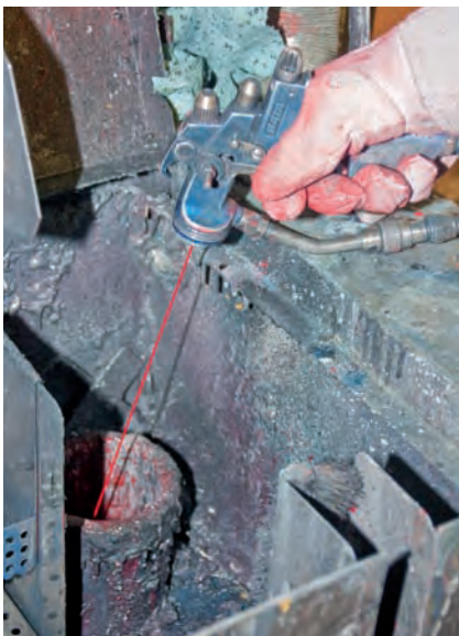
Schlauch und Pistole werden in dem 707-Airlesskleen ohne Aerosol-Bildung gereinigt.
