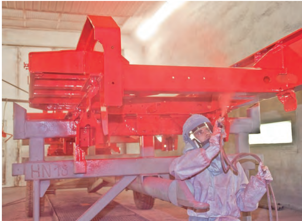
Lackiert wird meist zu zweit und Airless. Dabei fordern insbesondere die schwerer zugänglichen unteren Chassisbereiche eine gewisse Beweglichkeit vom Lackierer.
