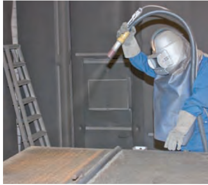
Das Strahlen der Chassis erfolgt mit Stahlgranulat – und innenbelüftetem Helm.
