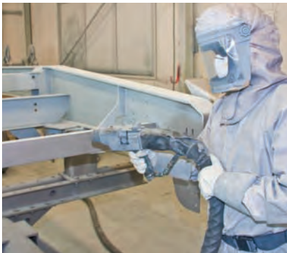
Das Spritzverzinken dauert etwa zwei Stunden und sorgt für extra hohen Korrosionsschutz.
