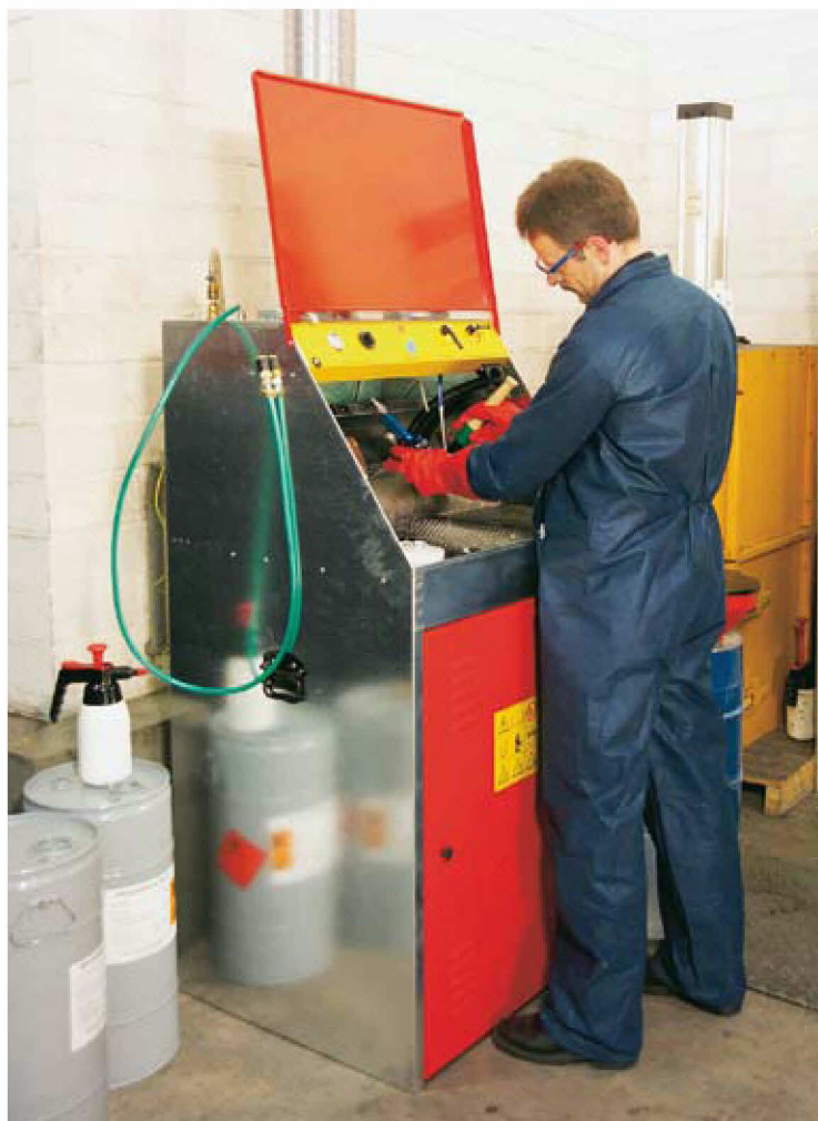
Die Reinigung der Lackierpistolen erfolgt in einem geschlossenen Medienkreislauf
